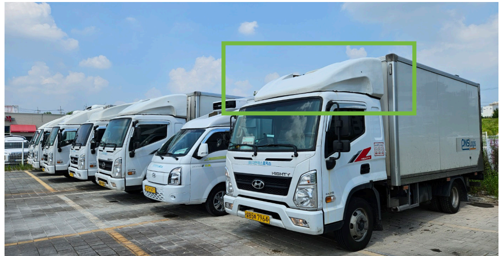
에어스포일러 설치 사진
